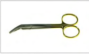
Drahtschere Tc mit Hartmetalleinsatz Mit Hartmetalleinsätzen. Bis Drahtstärken von 1 mm
